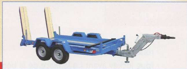
LX 350 avec timon à manivelle 3 m 50 x 1 m 70 PTC : 3500 kg -CU : 2800 kg
